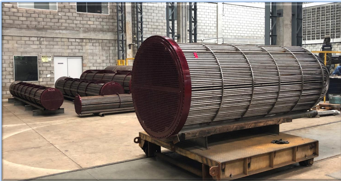
Hazes de Tubos – Tubos SA-179 / SA-312 Tp 304
